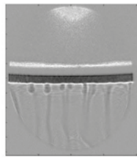
Dissolution du CO 2 dans l'eau à p = 2 Mpa visualisée par Shadowgraphie par le côté, configuration 2D
