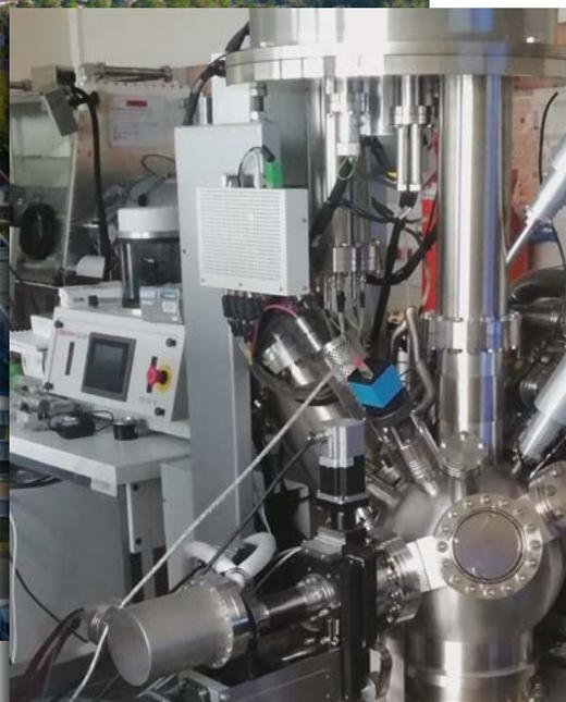
Appareillage XPS utilisé dans les recherches sur les batteries à l'IPREM.
