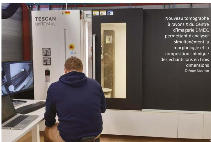
Nouveau tomographe à rayons X du Centre d'imagerie DMEX, permettant d'analyser simultanément la morphologie et la composition chimique des échantillons en trois dimensions
